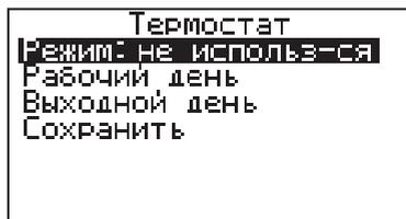
Настройте суточный или недельный цикл температуры воздуха в помещении или теплоносителя. Эти функции необходимы, если требуется поддерживать разную температуру днем и ночью, разную температуру по дням недели (например, если требуется отапливать помещение только по выходным дням).
