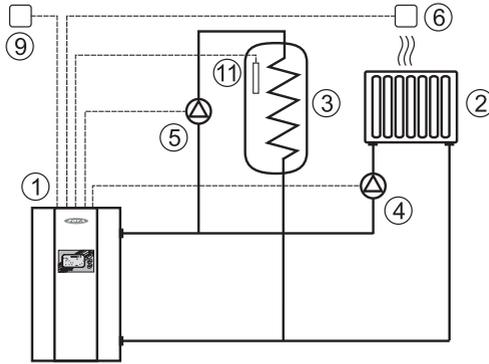
Рис.5 Упрощенная схема подключения котла с контуром ГВС.
