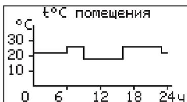
В случае использования многотарифной системы оплаты энергопотребления, можно настроить в периоды максимальных тарифов мощность 0 кВт, а в льготный (ночной) период установить максимальную мощность.
