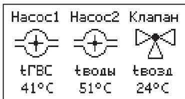
Работающий клапан отображается мигающим треугольником. Треугольник слева обозначает, что привод работает на открывание клапана. Треугольник справа обозначает, что привод работает на закрывание клапана.
