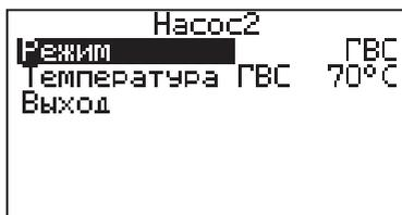
8.12. В меню «Насос2» настраивается режим работы насоса2, который может использоваться для работы в контуре ГВС или дополнительного контура отопления. Возможные режимы работы насоса2:
